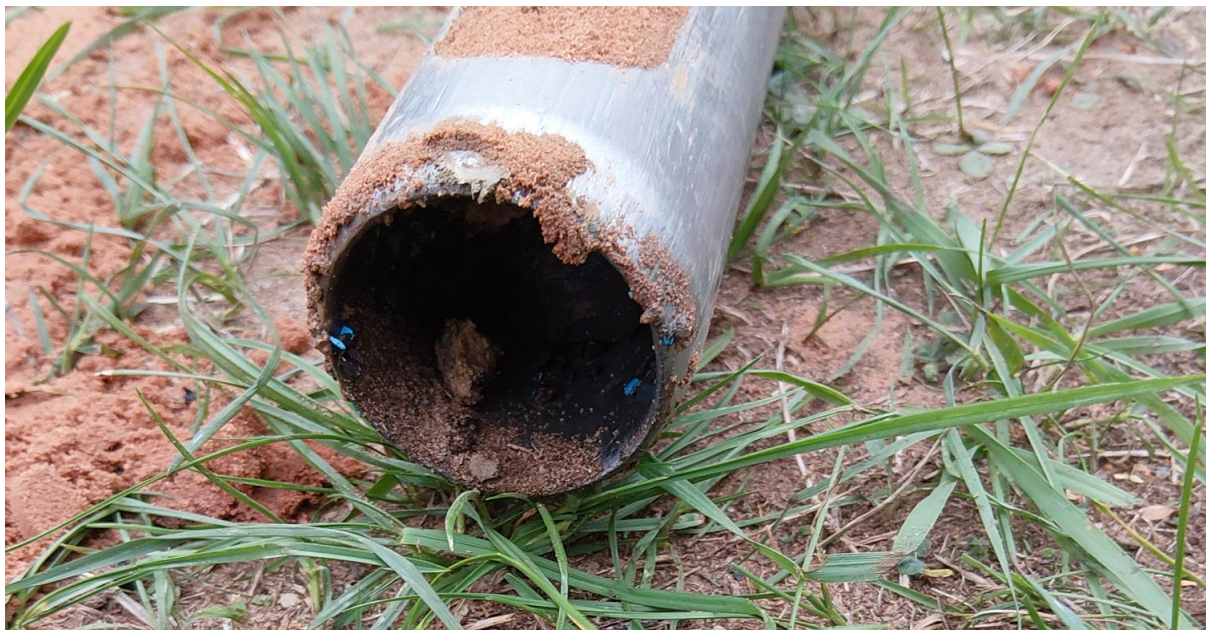
Foto 6: Detailfoto der Bohrkrone mit Farbresten
