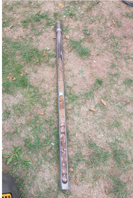
Foto 5: Bohrkern der Zusatzbohrung RKB 2
