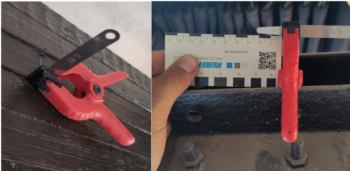
Abbildung 4 und 5 - Fühlerlehre mit 0,1 mm Stärke mit Tischlerklemme - Grottker
