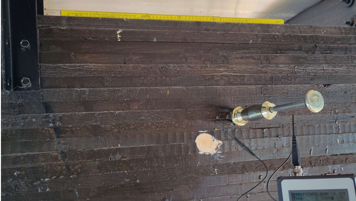
Abbildung 13 - Achse 12 JK - provisorisch verschlossene Bohrung, Holzfeuchtemessung bei 8,6 M% - Grottker
