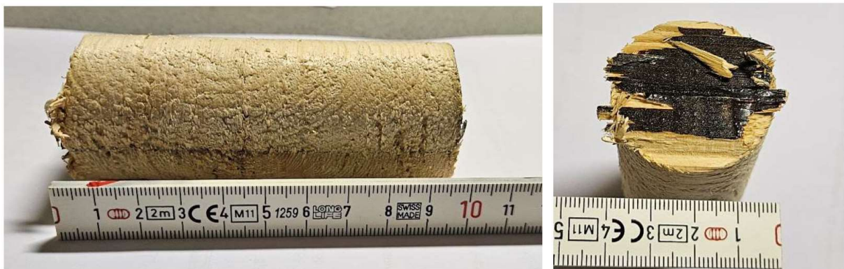
Abbildung 14 - entnommener Bohrkern aus dem Binder 12 [2]
