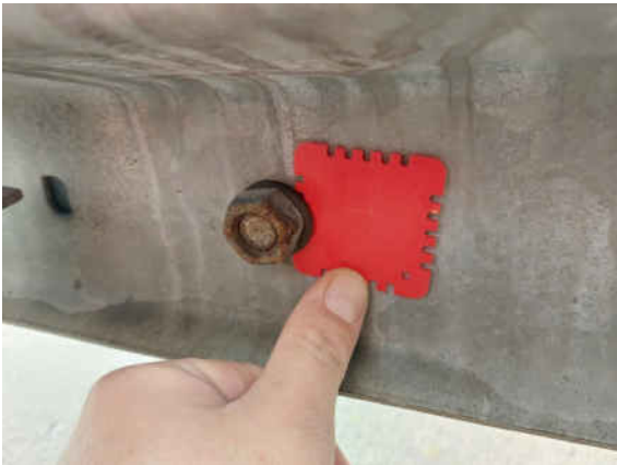
SN 041_2022H_R-EDSP PLANKENVERSCHRAUBUNG LOSE
