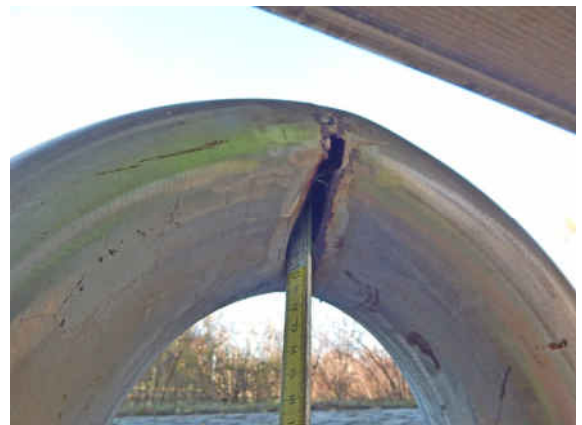
SN 041_0 2025E_H-KONTROLLSCHACHT L- LÜFTUNGSRÖHR OBEN GERISSEN
