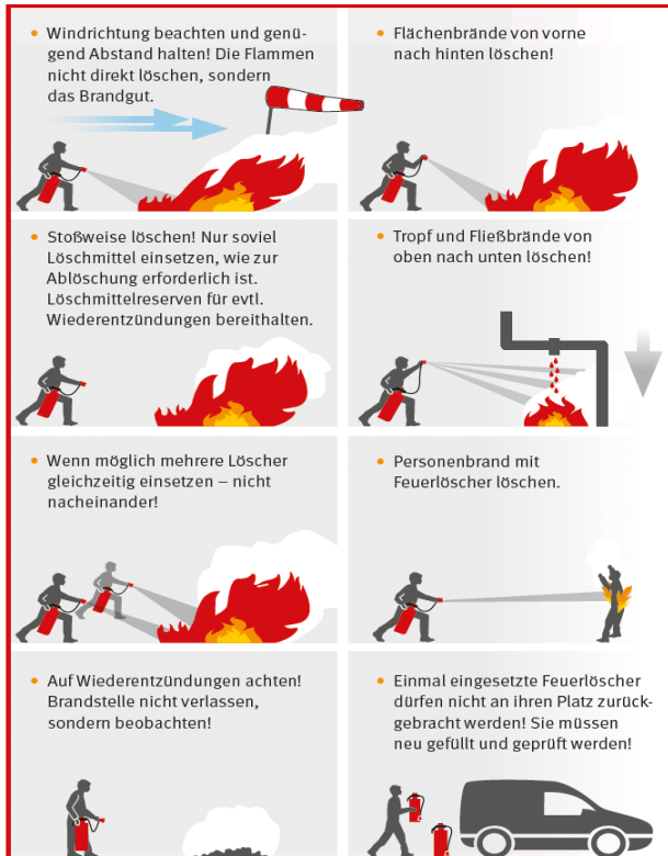
Feuerlöscher richtig einsetzen
