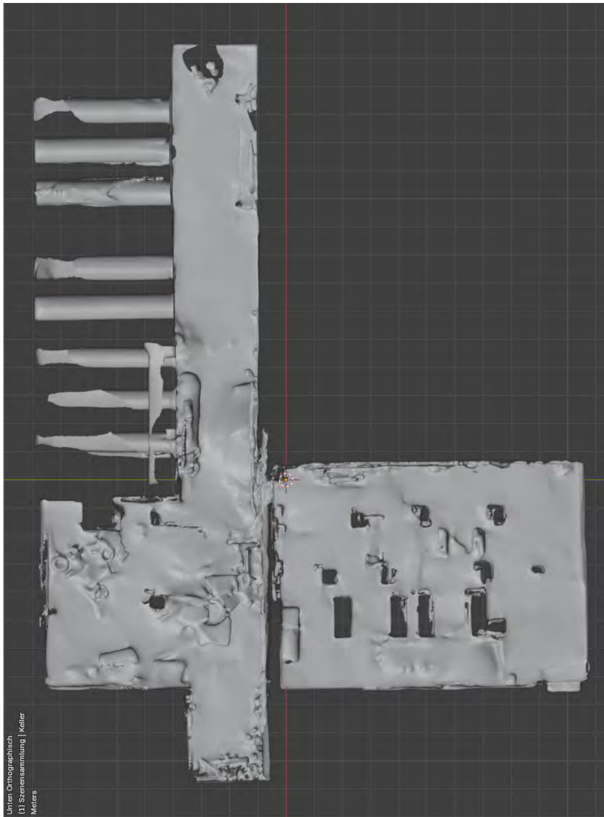
Abbildung 6 Ausschnitt des digitalen Oberflächenmodells des Kellergeschosses im Ofenhaus des ehemaligen Gaswerkes Pößneck, der umbaute Raum beträgt ca. 500 m³uR
