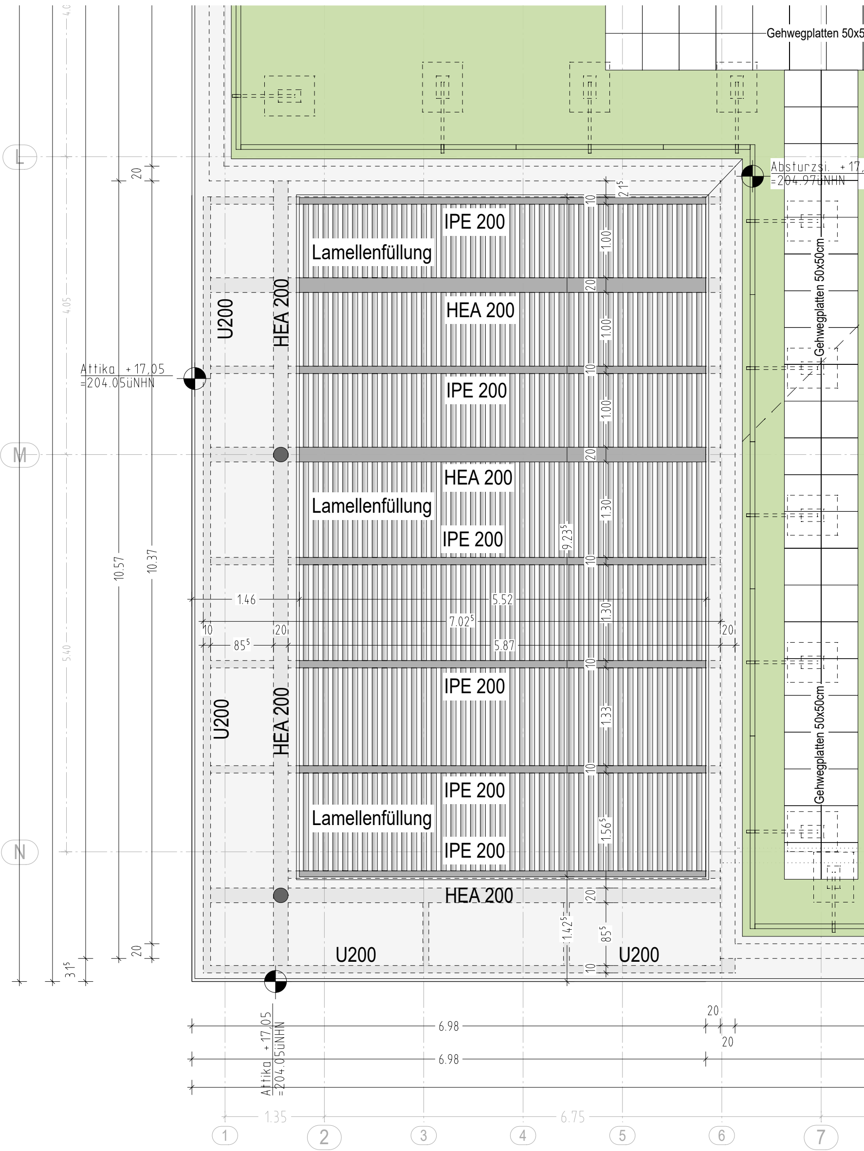
GRUNDRISS DACHAUFSICHT LAMELLENDACH
