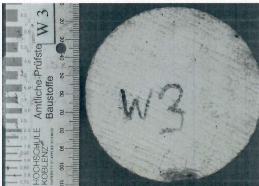
Bild 10: Bohrkern W3 Draufsicht
