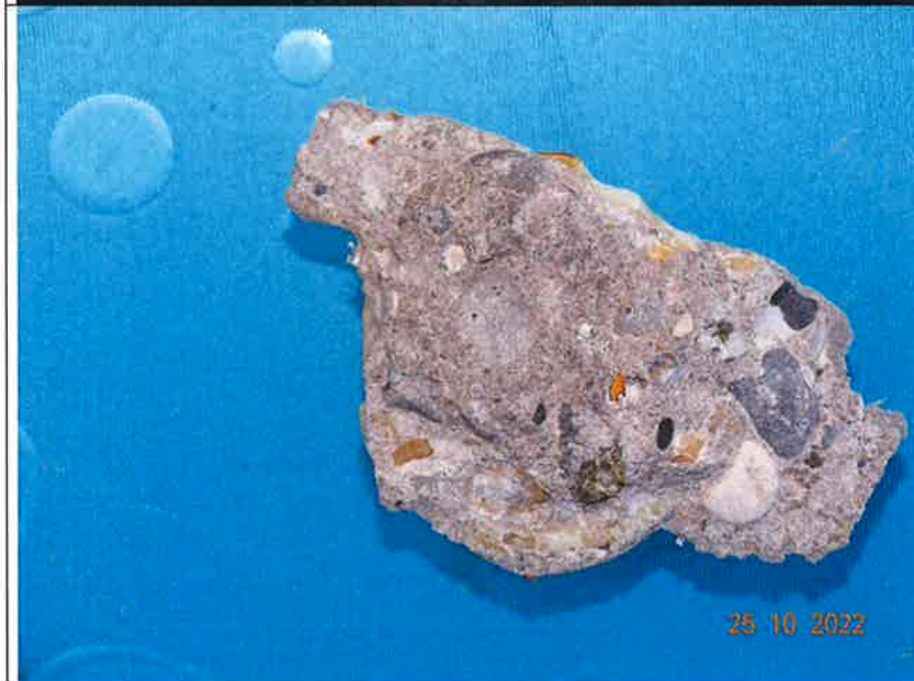
Detail: H9 Stempel nach Haftzugprüfung
