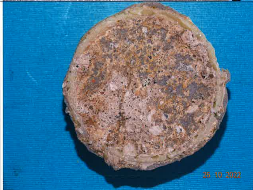
Detail: H4 Stempel nach Haftzugprüfung
