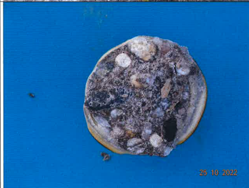
Detail: H5 Stempel nach Haftzugprüfung
