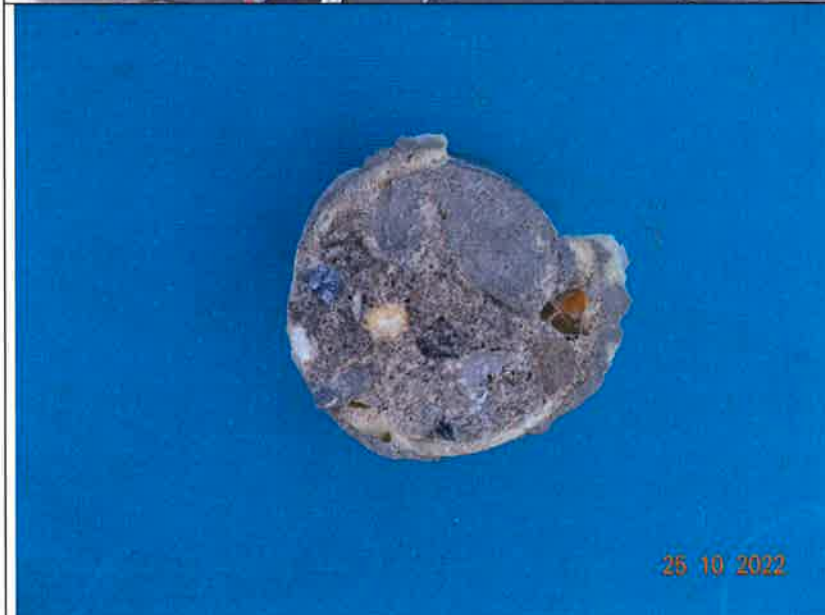
Detail: H3 Stempel nach Haftzugprüfung
