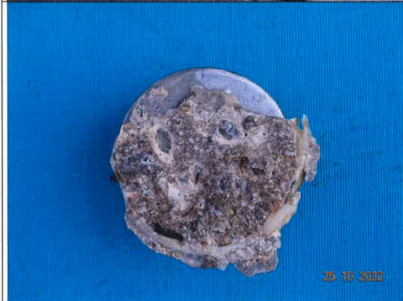
Detail: H8 Stempel nach Haftzugprüfung
