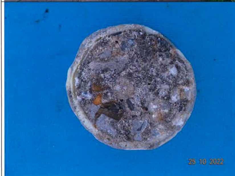
Detail: H2 Stempel nach Haftzugprüfung
