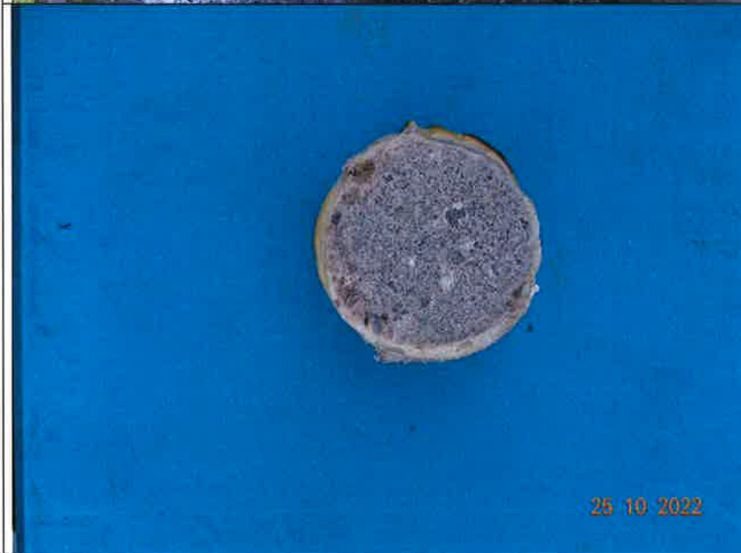
Detail: H6 Stempel nach Haftzugprüfung
