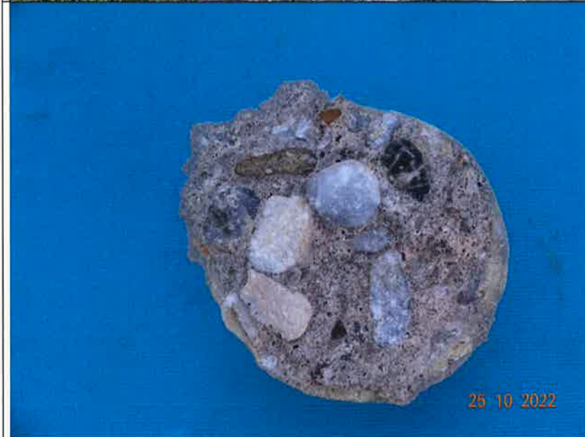
Detail: H1 Stempel nach Haftzugprüfung
