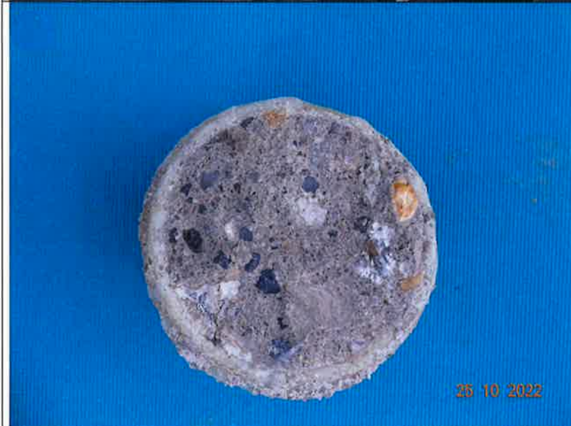
Detail: H10 Stempel nach Haftzugprüfung
