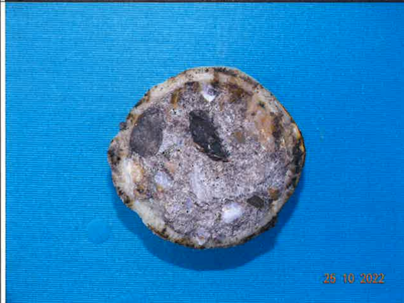
Detail: H7 Stempel nach Haftzugprüfung
