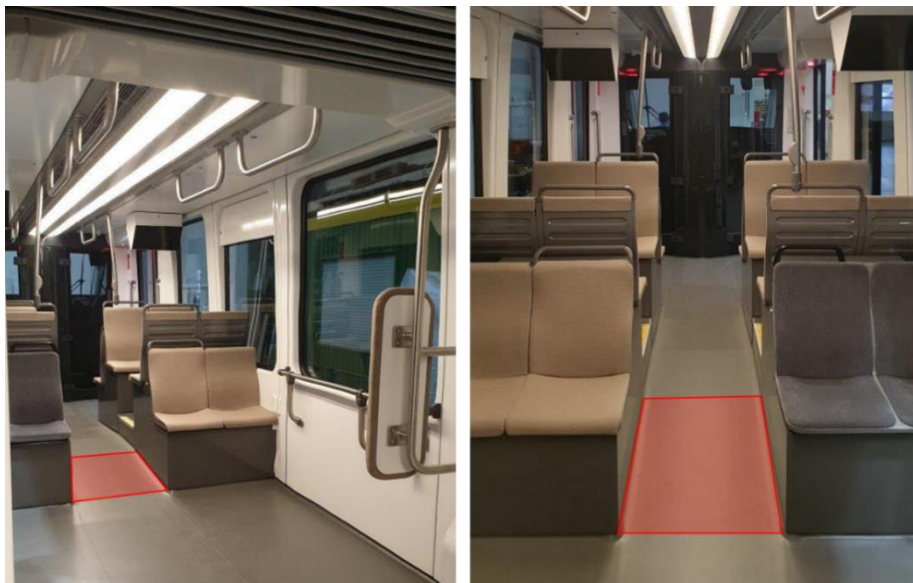
Abbildung 30 Längsrampen im Fahrzeug über den Fahrwerken
