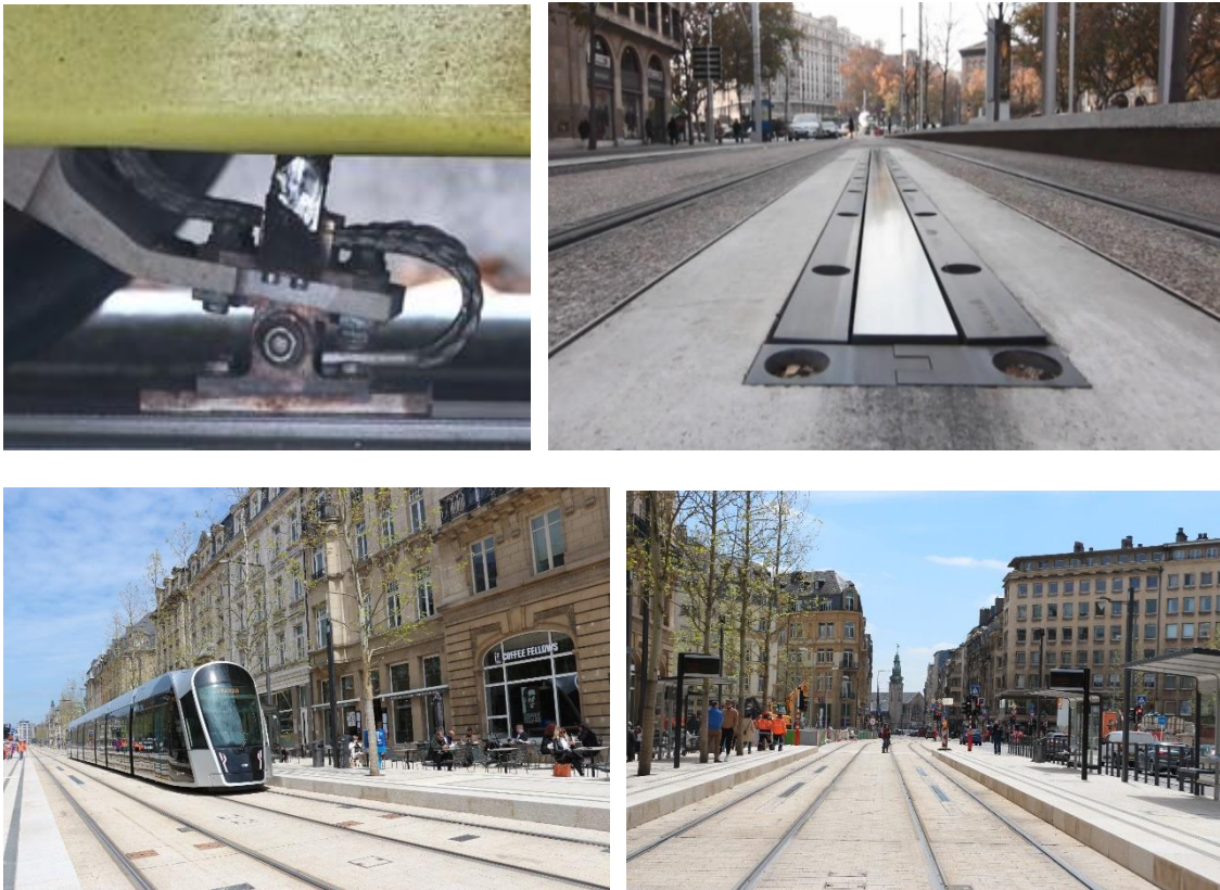
Abbildung 38: Tram Luxembourg, Stromzuführung aus dem Gleisbett an Haltestellen (Quelle: Stadt Luxembourg)
