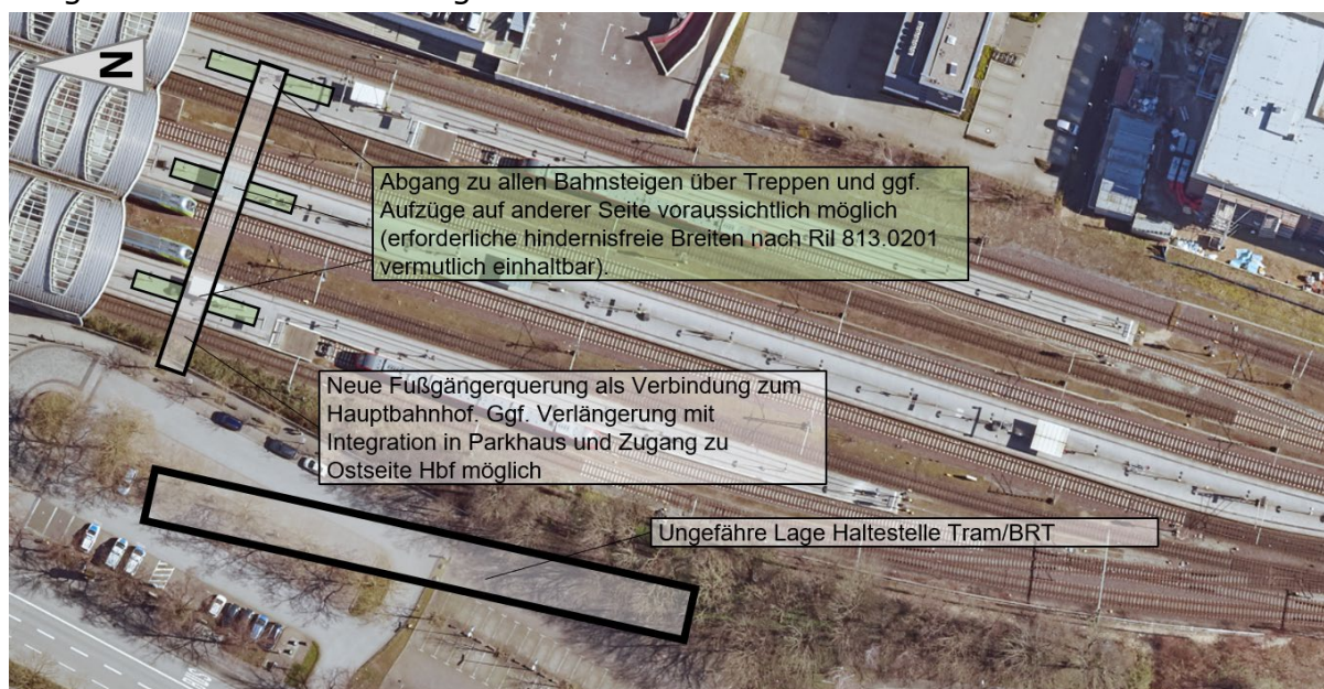
Abbildung 43 Neue Fußgängerquerung mit Treppenabgängen Variante 2. Technisch nach erster Grobprüfung vermutlich machbare Lösung
