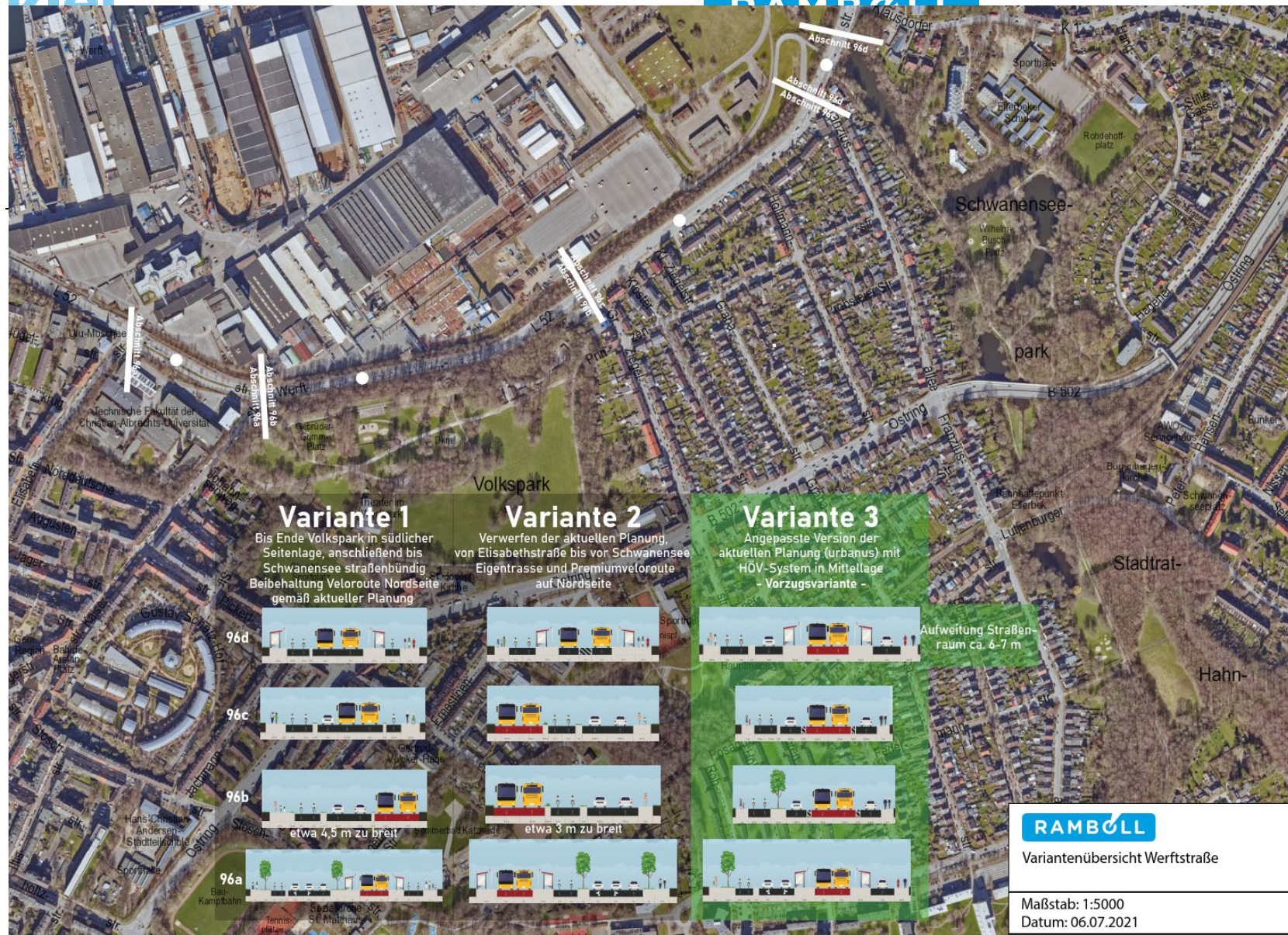
Abbildung 13 Beispieldarstellung Variantenübersicht des semihomogenen Abschnitts Werftstraße (Ausschnitt), Quelle: Ramboll. Querschnittsskizzen auf Basis von Streetmix ( www.streetmix.net – CC-BY-SA 4.0)
