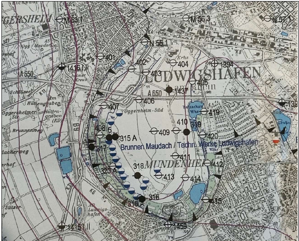
Bild 2: Höhengleichen des oberen Grundwasserleiters am 01.10.1990 (vgl. Unterl. Ziffer 2.5)
