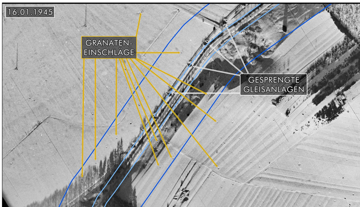
Abb. 4: Zahlreiche Geschützgranateneinschläge auf Freiflächen sowie an mehreren Stellen gesprengte Gleisanlagen im Süden des Projektgebietes, exemplarisch markiert im Luftbild vom 16.01.1945 mit Schneebedeckung (Flug-Nr. 31-3998, #1142).
