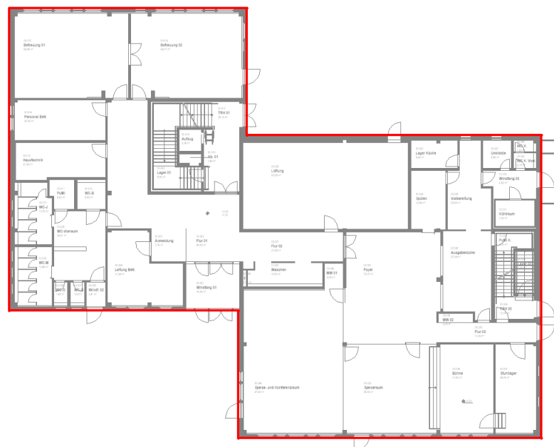
Abbildung 1: Markierung der thermischen Hülle (rot) beispielhaft im Erdgeschoss, Verlauf der thermischen Hülle im 1. Obergeschoss analog
