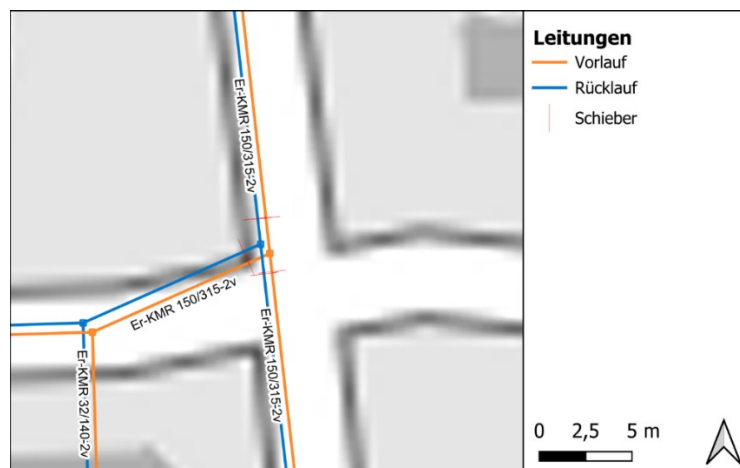
Abbildung 2-12: Beispiel für ein Schieberkreuz im Wärmenetz in der Ringstraße
