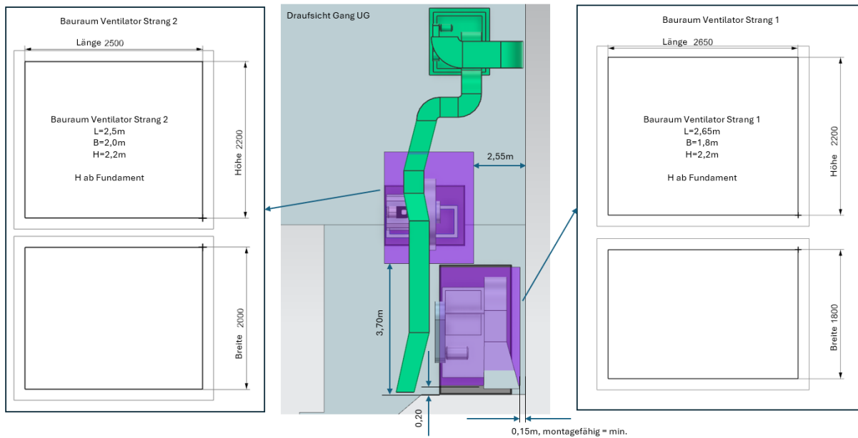
Abbildung 3 Aufstellraum der Ventilatoren, Draufsicht
